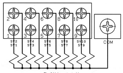
Fig. 3 Valve output wiring
